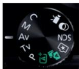
Bei der **Zeitautomatik AV** gibst du den Blendenwert vor, die Kamera wählt automatisch die passende Belichtungszeit.
