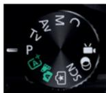
Bei der **Programmautomatik P** stellt die Kamera Blendenwert und Belichtungszeit automatisch ein.
