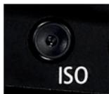
Der **ISO-Wert** bestimmt die Lichtempfindlichkeit des Bildsensors: Hohe ISO-Werte ermöglichen kürzere Belichtungszeiten oder kleinere Blendenöffnungen für mehr Schärfentiefe.
